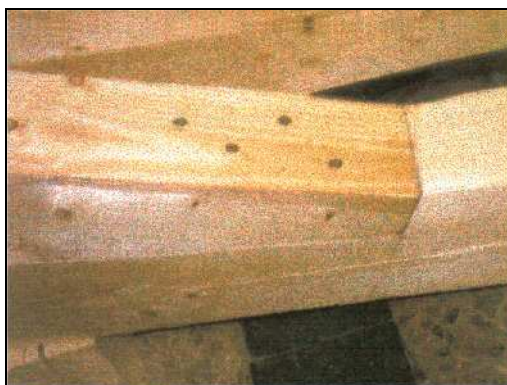
Figura 19: Immagine del nodo rinforzato con 4 chiodi
